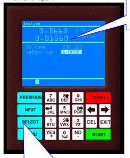
Удобная мембранная клавиатура позволяет вводить цифровые и буквенные обозначения, а также с ее помощью можно управлять работой прибора и осуществлять выбор различных аналитических опций.
