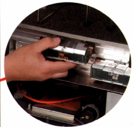
В приборе используется метод сжигания в потоке кислорода. Взвешенная проба (1 грамм) в керамическом тигле сжигается в потоке кислорода. При этом углерод и сера из пробы, независимо в каких формах они находятся в образце, окисляются.
