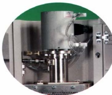
**Программируемая автоматическая очистка** обеспечивает чистку фильтра и печи сжигания с одновременным удалением пыли и оставшихся продуктов горения
