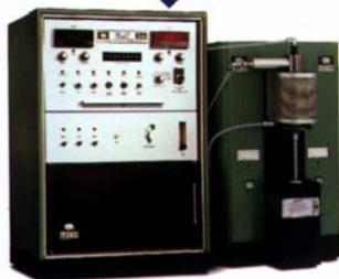
Следующим шагом стал анализатор для одновременного измерения серы и углерода с ИК детекторами с улучшенной точностью
